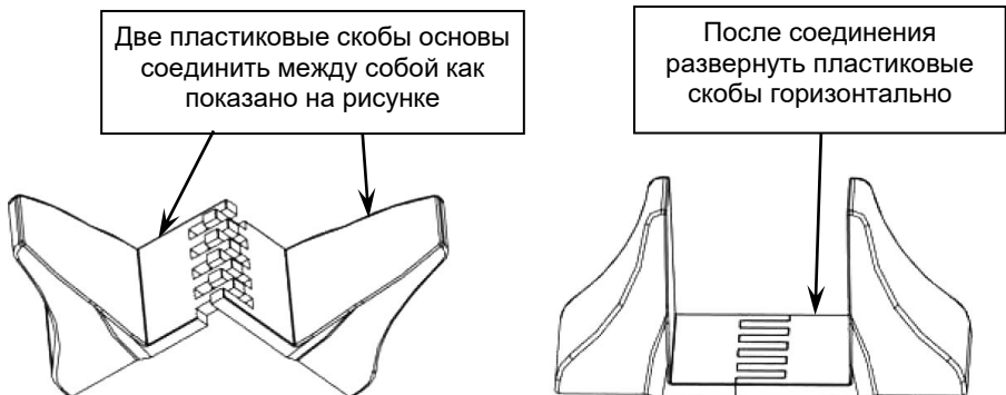
Рисунок 3 - Сборка пластиковых основ для вертикальной установки изделия.
